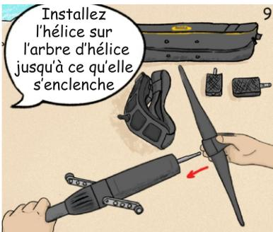
9. Installez l'hélice sur l'arbre d'hélice jusqu'à ce qu'elle s'enclenche
