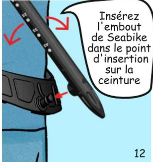
12. Insérez l'embout de Seabike dans le point d'insertion sur la ceinture
